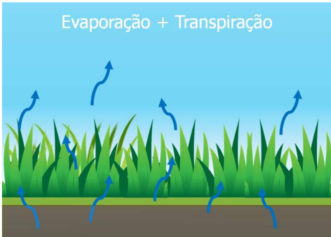
Figura 4: Exemplificação da Evapotranspiração potencial ou de referência: em condições meteorológicas padrão, com cultura de referência e solo sem restrição hídrica.
